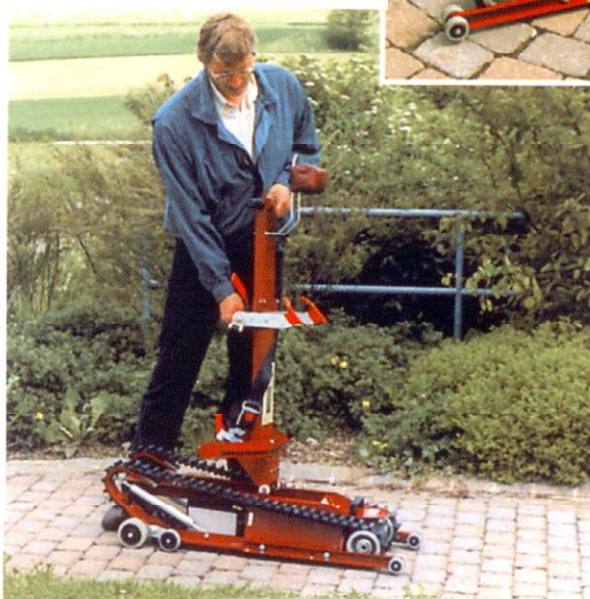
Introducir el adaptador en las guías
